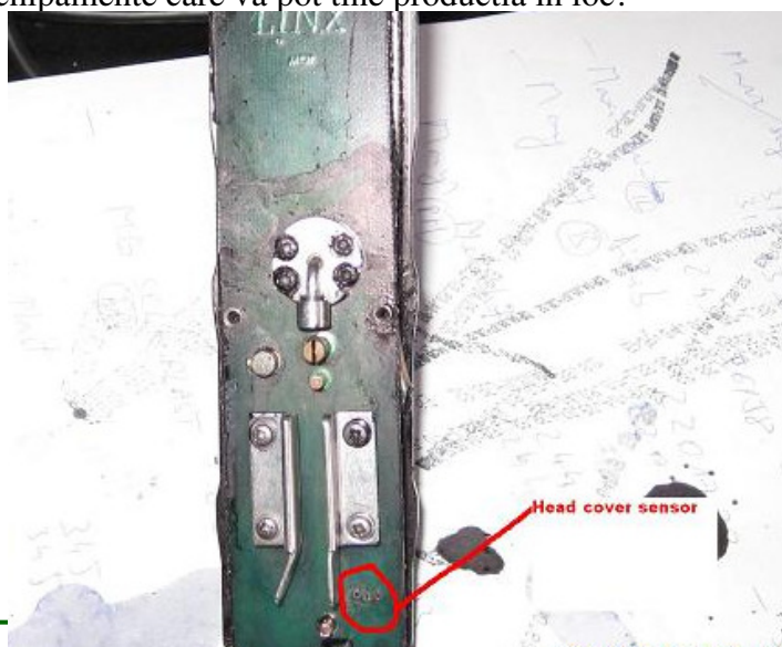
“Reparatie”...Capul de scriere a fost desigilat senzorul de prezenta a capacului a fost distrus.
